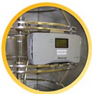
LS-200 spektroradiometer monteret i Ci-kammer.
