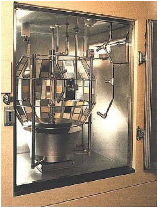
En vejmaskines indre. Bemærk den centrale Xenon-brænder, og de perifert anordnede dyser til vandpæsprøjtning.
