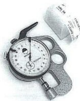
Plastisk deformérbar film til ruhedsbedømmelse. Filmens tykkelse måles efter at have taget aftryk af overfladen.
