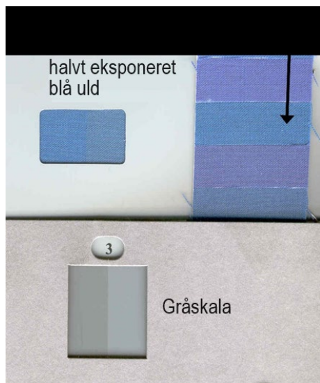
ISO Blå Uld nr. 6 før (højre) og efter (venstre) en eksponeringsperiode iht. ISO 105-B06.
