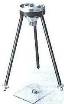
Fig. 2. "DIN"-udløbsbæger. Bemærk libellen forneden i billedet. Med den kan bægeret justeres i vater.
